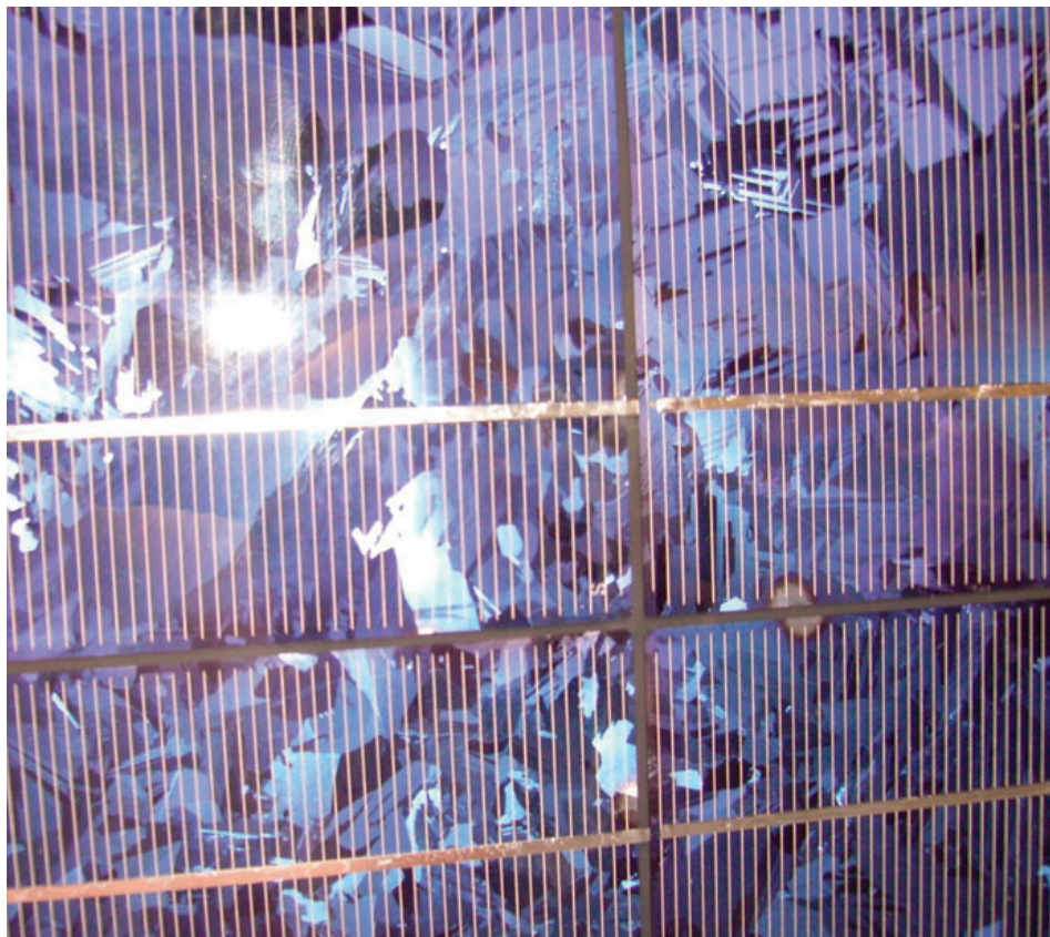
Cellules photovoltaïques poly cristallines exposées lors du salon romand consacré aux énergies renouvelables: Energissima.
