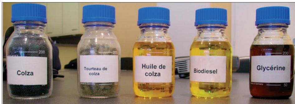
Différents éléments du colza au bio diesel produits sur le site d'Etoy; il faut 3 tonnes de colza pour produire 1000l de bio diesel.
